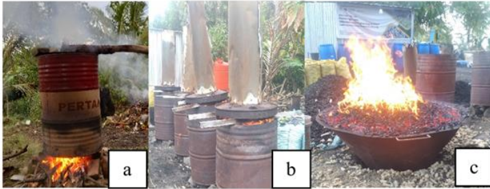
Gambar 5. 2. Proses pembakaran tongkol jagung dalam pembuatan biochar: a. Pembakaran menggunakan metode kiln drum; b. Pembakaran menggunakan TLUD; c. Pembakaran menggunakan kontiki
